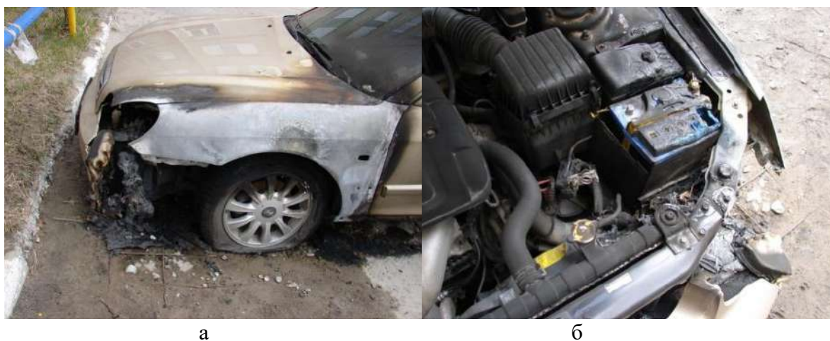
а б Рис. 8. Автомобиль Hyundai после пожара: а – передняя часть правой стороны; б – аккумуляторная батарея
