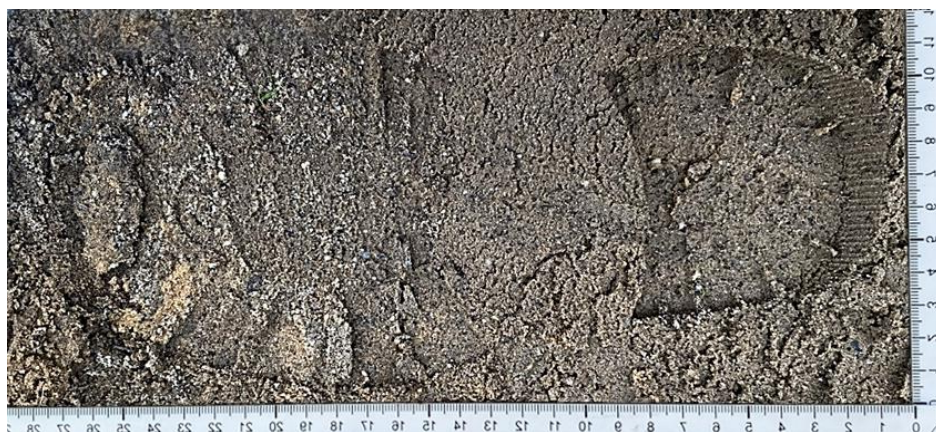
Рис. 10. След подошвенной части обуви на влажной супеси сразу после его образования.
