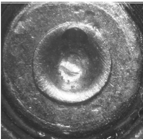
Рис. 3. Следы бойка ударника и краев канала для бойка в чашке затвора
