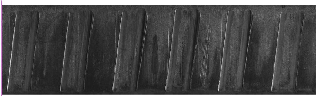
Рис. 2. Фоторазвертка пули, выстреленной из 9,0 мм пистолета ПЛК
