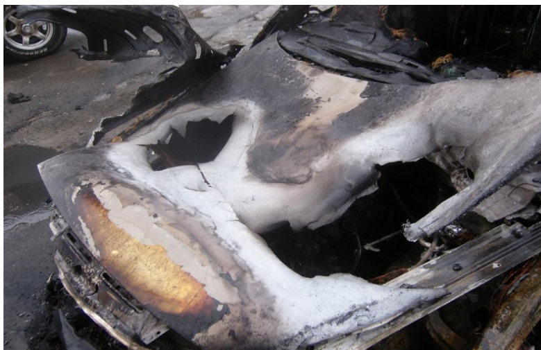
Рис. 3. Крышка капота из алюминиево-магниевого сплава с двумя локальными прогарами
