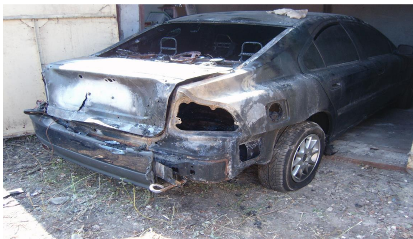
Рис.1. Термическая деформация крышки багажника сгоревшего автомобиля
