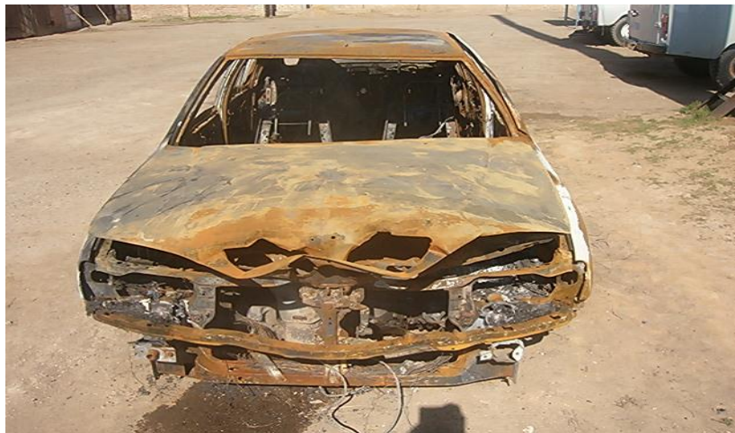
Рис. 2. Следы деформации крышки капота сгоревшего автомобиля в результате механического воздействия при тушении пожара
