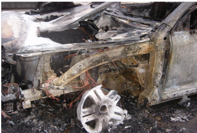
Рис.4. Локальное выгорание алюминиевого диска колеса указывает на местоположение очага пожара
