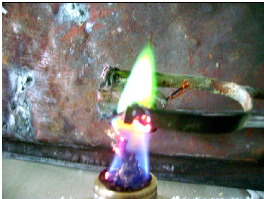
Рис. 4. Проба Бельштейна. Цвет пламени при сгорании ПВХ
