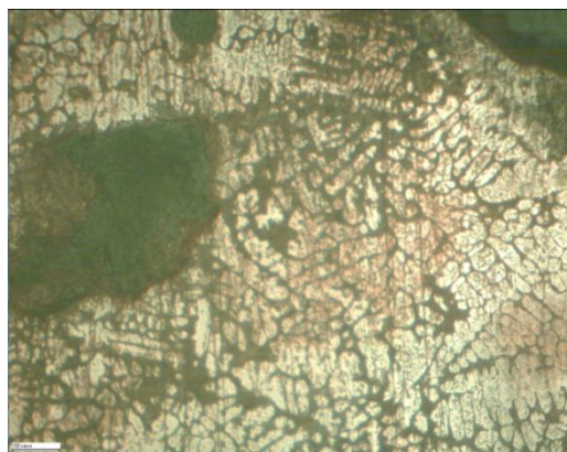
Рис. 1. Микроструктуры шлифов медных проводников сечением 1\text{мм}^2 , полученных при токах перегрузки: а) 65А; б) 80А; в) 150А; г) 200А; д) 300А
