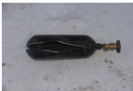
Рис.6. Повреждение баллона с углекислым газом в результате взрыва
