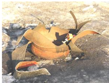
Рис.8-9. Возможные повреждения баллонов с пропан-бутаном
