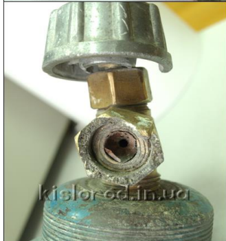
Рис.1 - 3. Горловина баллона, фрагменты корпуса баллона, вентиль баллона после взрыва
