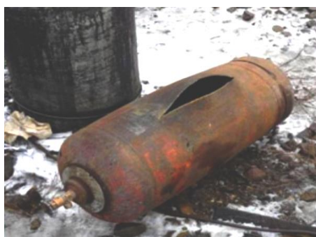
Рис.8-9. Возможные повреждения баллонов с пропан-бутаном
