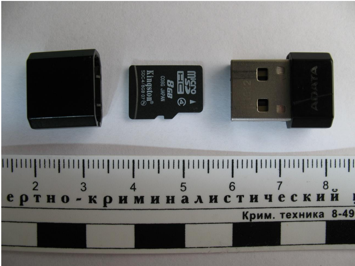
Рис. 4. Внешний USB-картридер стандарта MicroSDHC со сменной картой памяти (в разобранном состоянии)
