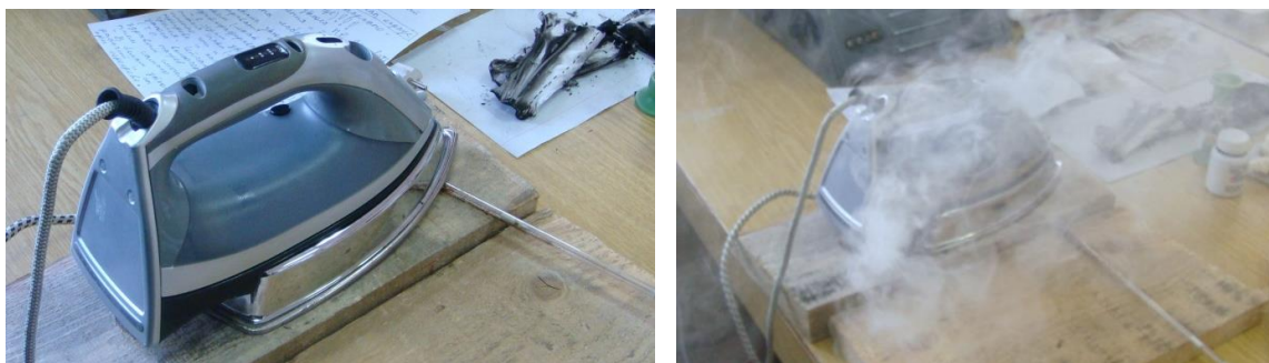
Рис. 6. Исследование зажигательной способности электроутюга № 1 при воздействии на деревянное покрытие
