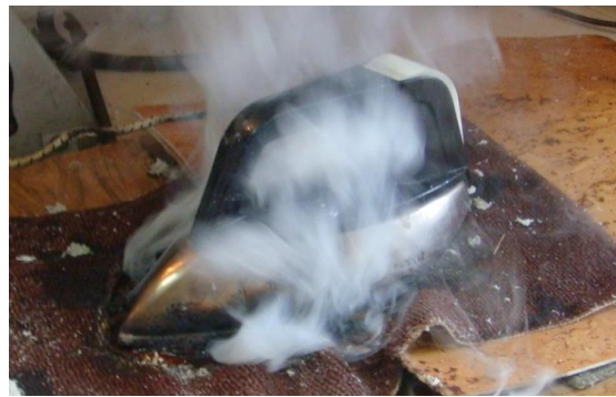
Рис. 10- 11. Исследование зажигающей способности электроутюга №3 при воздействии на поверхность, моделирующую деревянный пол, покрытый ковром и деревянный пол, покрытый линолеумом и сверху ковровым изделием
