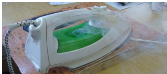
Рис. 3-4. Исследование зажигательной способности электроутюга №1 при воздействии на линолеум
