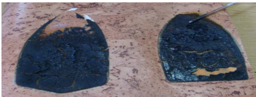
Рис. 5. Термические повреждения линолеума, образовавшиеся в результате термического воздействия рабочих поверхностей электроутюгов №1, №2
