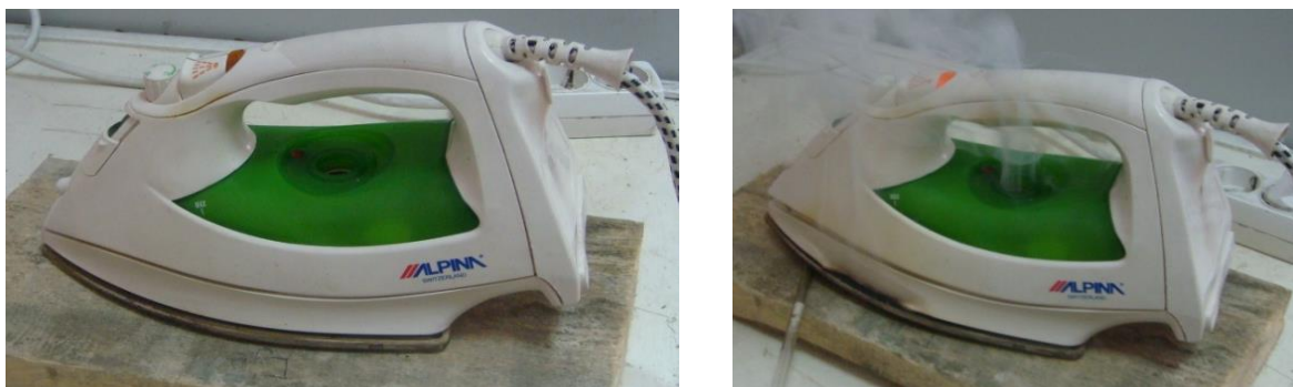
Рис. 8- 9. Исследование зажигательной способности электроутюга №2 при воздействии на деревянное покрытие
