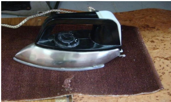
Рис. 10- 11. Исследование зажигающей способности электроутюга №3 при воздействии на поверхность, моделирующую деревянный пол, покрытый ковром и деревянный пол, покрытый линолеумом и сверху ковровым изделием
