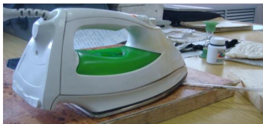
Рис. 3-4. Исследование зажигательной способности электроутюга №1 при воздействии на линолеум
