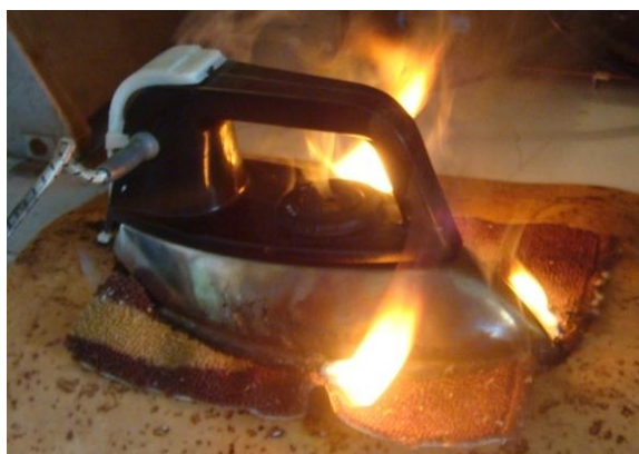
Рис. 12 – 13. Исследование зажигательной способности электроутюга №3 при воздействии на поверхность, моделирующую напольное деревянный пол, покрытый линолеумом, а сверху ковровым покрытием
