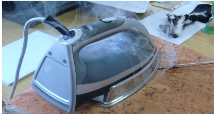
Рис. 1-2. Исследование зажигательной способности электроутюга №1 при воздействии на линолеум
