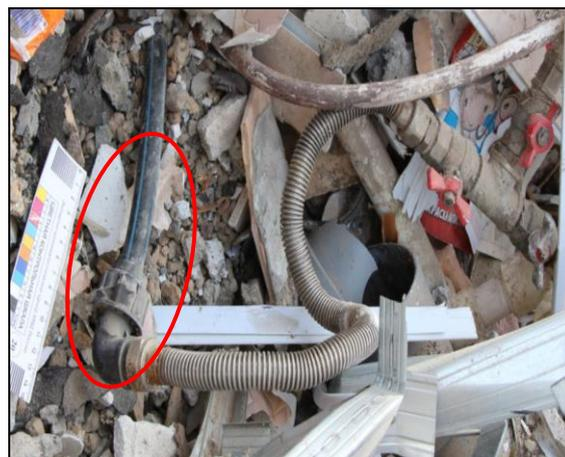
Рисунок 10. Газовая магистраль с соединительным шлангом.
