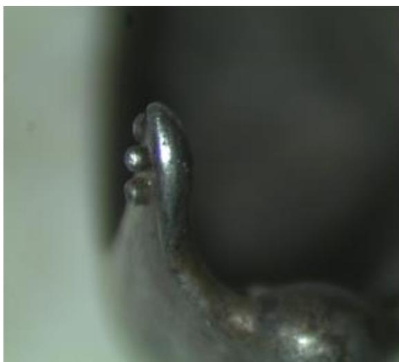
Рисунок 7. Частицы металла сферической формы на поверхности обжимной гильзы
