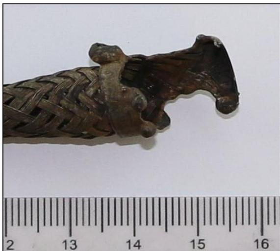
Рисунок 6. Повреждение обжимной гильзы газового шланга
