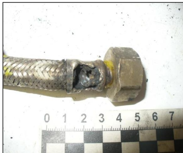
Рисунок 9. Повреждение гибкого газового шланга
