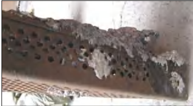
Рисунок 4. Внешний вид электрообогревателя с наплавлениями и подтеками серебристого цвета
