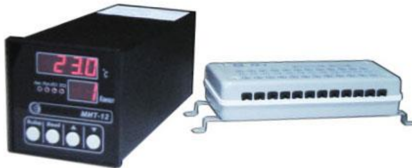
Рис. 1. Многоканальный измеритель температуры МИТ-12-ТП-11 с устройством компенсации УК-2
