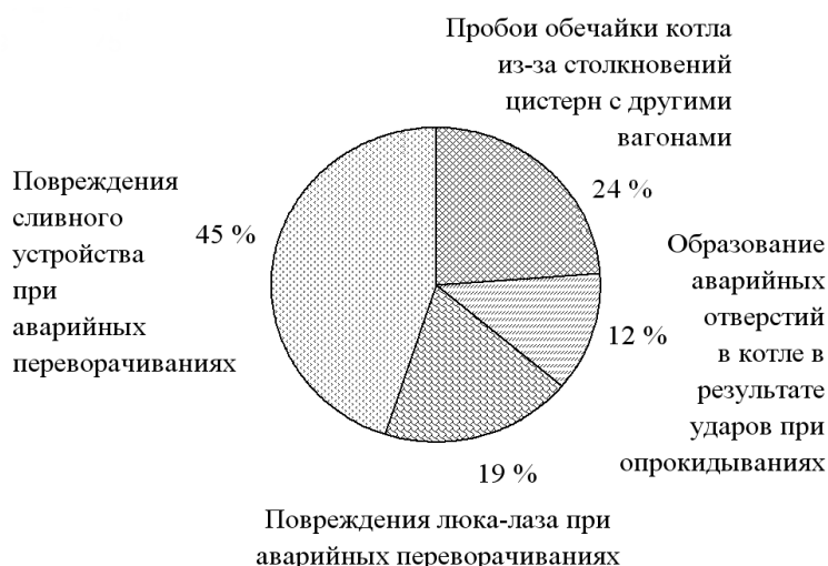
Рис. 2. Причины выброса нефти и нефтепродуктов из железнодорожных цистерн при авариях
