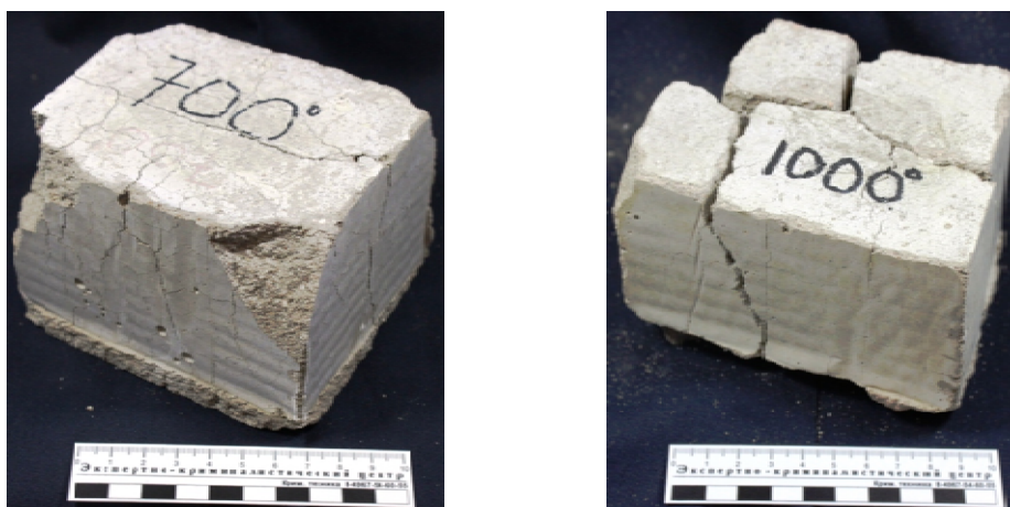
Рис. 1-2 – образцы цементного камня, подвергшиеся тепловому воздействию при температурах 700 °С и 1000 °С
