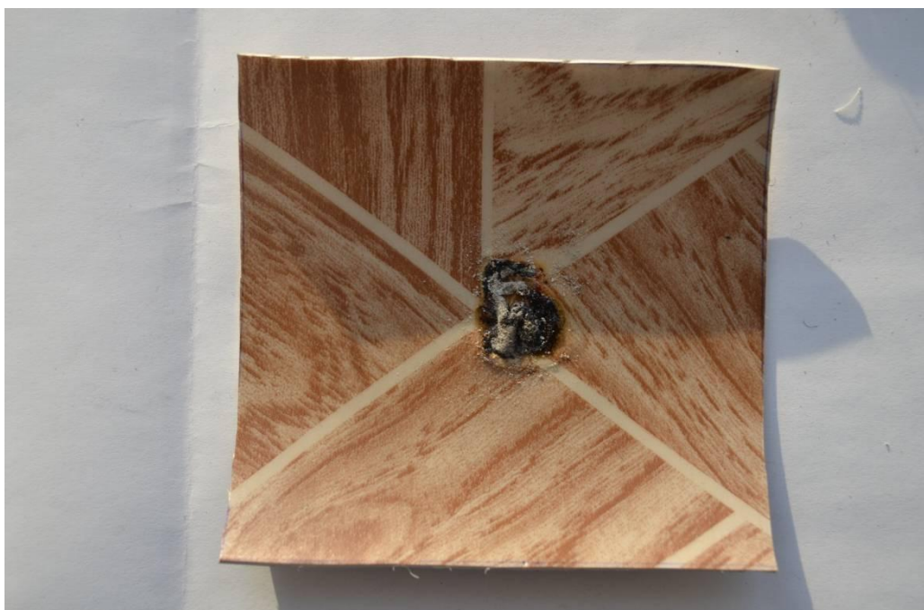
Рис. 7. Результат эксперимента с линолеумом поливинилхлоридным
