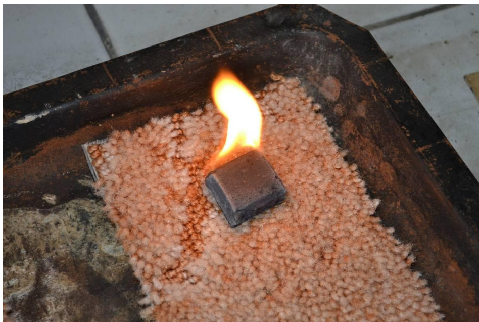
Рис. 6. Результат эксперимента с длинноворсным ковровым покрытием
