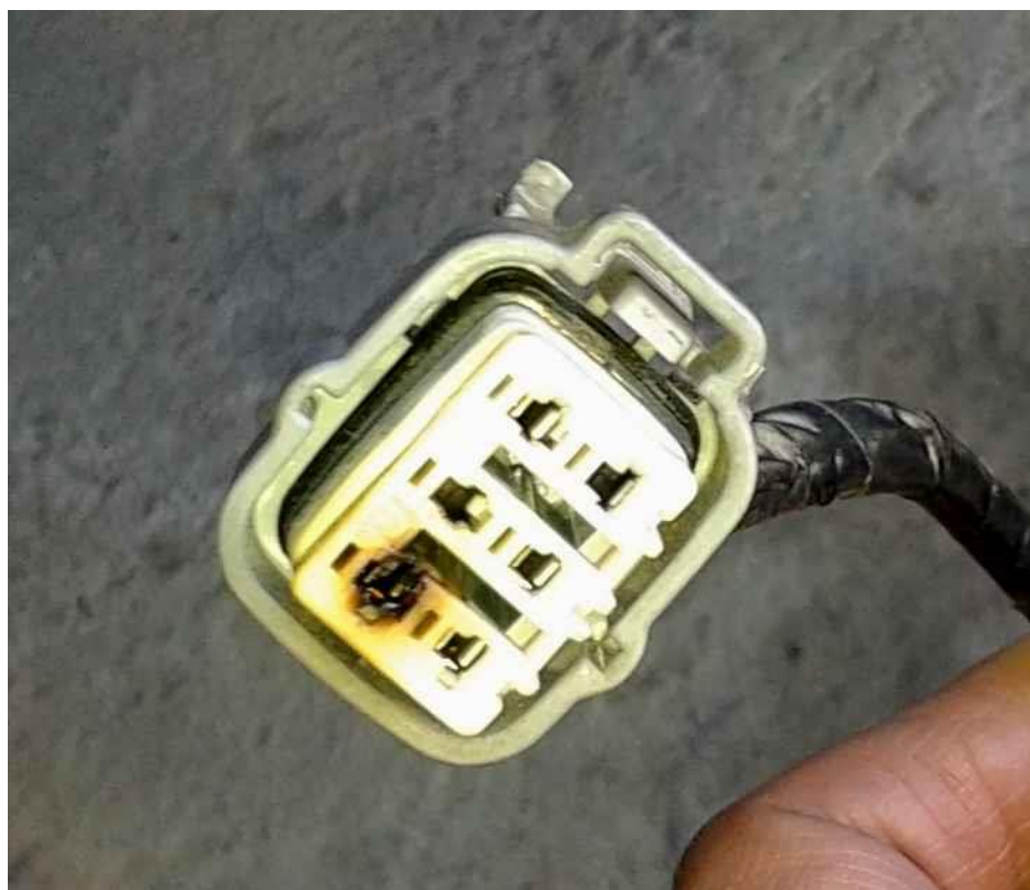
Рис. 3. Возникновение БПС в ответной части клеммного разъёма топливного насоса Subaru Forester 2004 года выпуска
